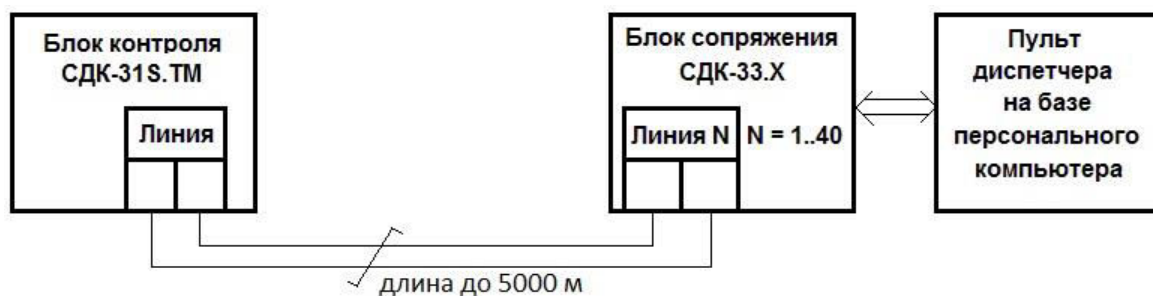
Рисунок 2. Подключение блока контроля к пульту диспетчера
